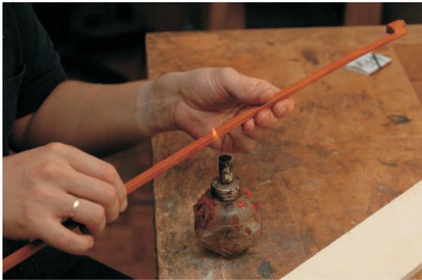
ist als das Endprodukt. Bei einer guten Holz Auswahl ist die Stange in diesem Zustand nahezu gerade.
